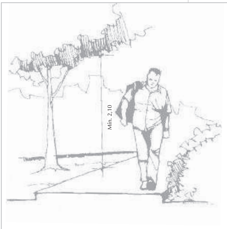
Fig. 158: No passeio, os ramos de árvores devem estar acima de 2,10 m e os arbustos não devem interferir na faixa de circulação
